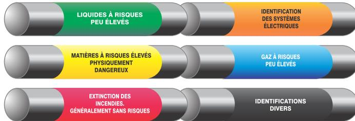
Des conduits identifiés adéquatement éliminent de façon substantielle les risques d'accidents lors d'entretien, de manipulation ou de rupture des conduits. Bien que la majorité des entreprises prônent la norme ANSI et CSA, plusieurs d'entre elles demandent la norme européenne (ACFOR), combinée avec les précédentes, principalement dû au choix de couleurs supplémentaires disponibles.
